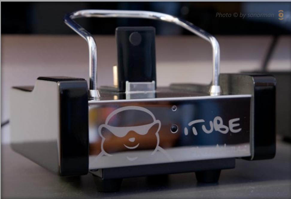
**Links:** Das iPod Dock des Fatman iTube. Hinter dem Dock-Connector ist die Plastikstütze zu erkennen, die vor Beschädigung des Anschlusses durch ungerades Aufstecken oder Abziehen des iPod verhindern soll. Der Chrombügel dient nur der Optik.
