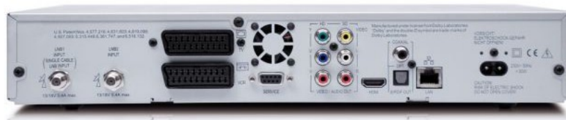
Fast alles da: Links die zwei Antenneneingänge. Über HDMI wird auch Dolby Digital ausgegeben. Den kleinen Lüfter über der seriellen Schnittstelle hätte Technisat sich gerne verkneifen dürfen.
