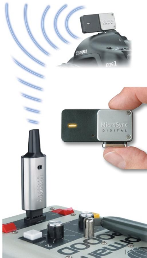
re lang halten soll. Der Empfänger kommt mit zwei Mignon-Batterien ca. 1 Jahr aus. Die kürzeste Blitzsynchro-Verschlusszeit beträgt 1/180s bei Schlitzverschluss und 1/350s bei Zentralverschluss.
