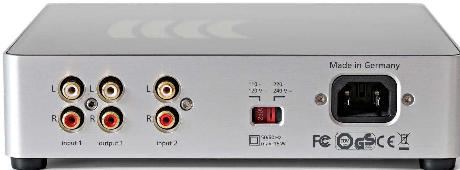
A 2 Rückseite: "output 1" ist direkt von "input 1" durchgeschleift und nicht in der Lautstärke regelbar. Die Kaltgerätebuchse rechts deutet auf das integrierte Netzteil hin. Der A 2 kommt ohne "Wandwarze" aus.
