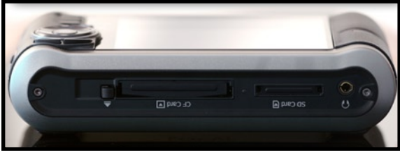
Oberseite: Hier finden sich die Kartenslots für CompactFlash und für SD-Karten, sowie der Kopfhöreranschluss.
