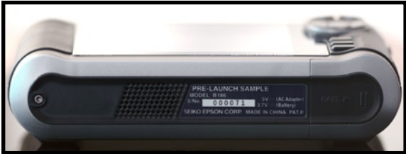
Unterseite: Rechts das Akku-Fach, Mitte-Links der integrierte Mini-Lautsprecher.
