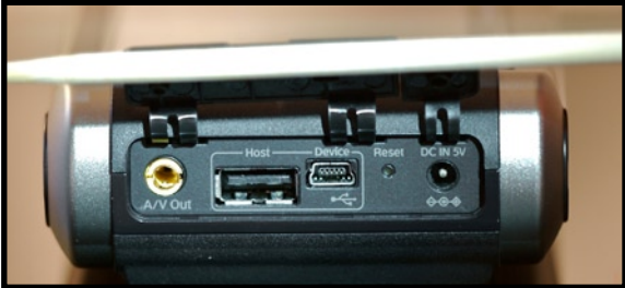
Schnittstellen: v.l.n.r.: Analoger Videoausgang, USB für Host- und Device-Betrieb, Reset-Taste, Netzanschluss. Insbesondere die Abdeckung des Netzanschlusses ist sehr fummelig.
