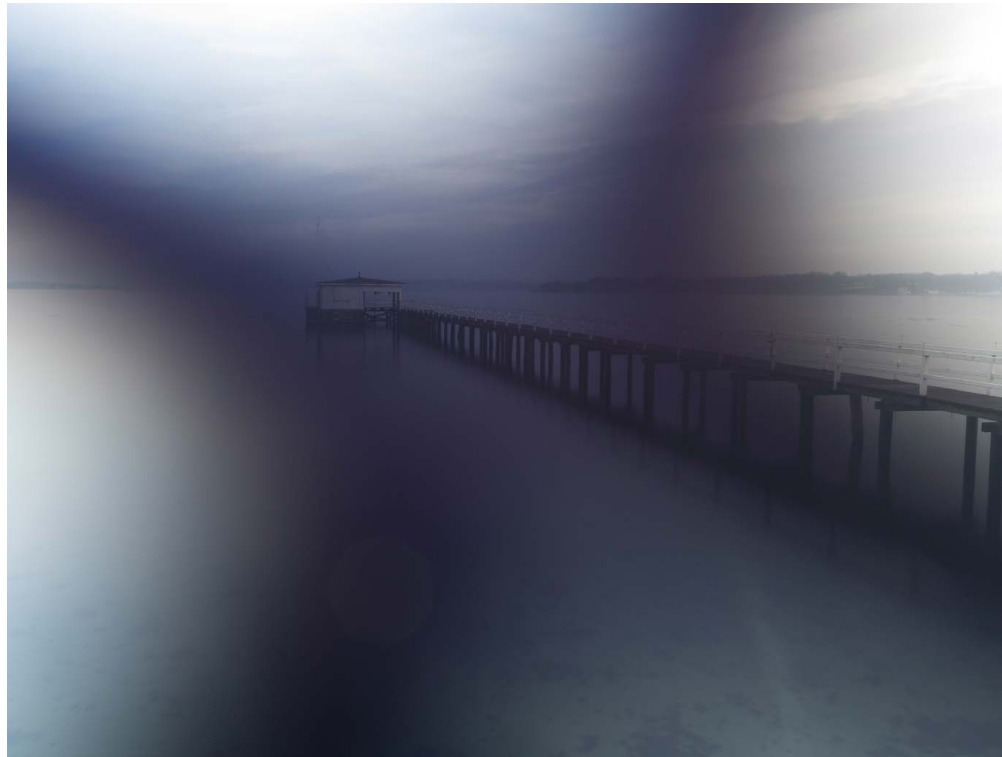
Autsch: Bei stärkster Einstellung erzeugt der NDX-Filter heftige Interferenzmuster. Aufnahme: 15s, f/7,1 bei ISO 100.
