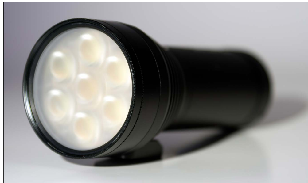
Diffusor (Vorserie): Durch das milchige Glas wird eine weichere, gleichmäßigere Lichtverteilung erzielt, was für fotografische Zwecke sehr vorteilhaft ist. Dank Schraubgewinde können auch andere Filter mit einem Durchmesser von 55 mm an der Betty genutzt werden.
