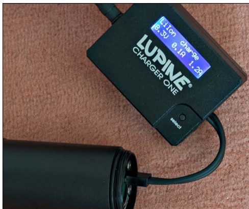
Das Ladegerät Charger One informiert genau über die Akkuspannung, den Ladestrom und die bereits geladene Kapazität.
