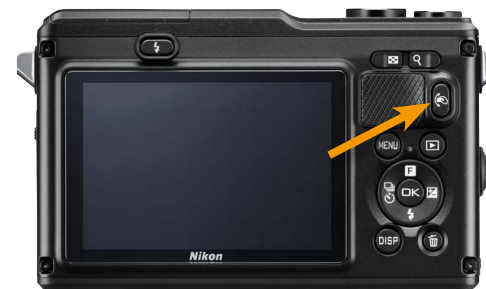
Unten: Action Control-Menü. Einfach Taste drücken (Pfeil oberes Bild) und die Kamera schwenken, um die gewünschte Funktion zu aktivieren
