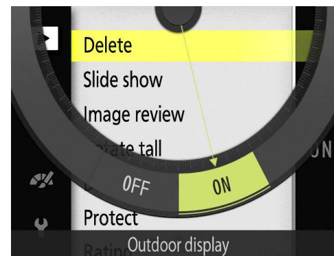
Unten: Action Control-Menü. Einfach Taste drücken (Pfeil oberes Bild) und die Kamera schwenken, um die gewünschte Funktion zu aktivieren
