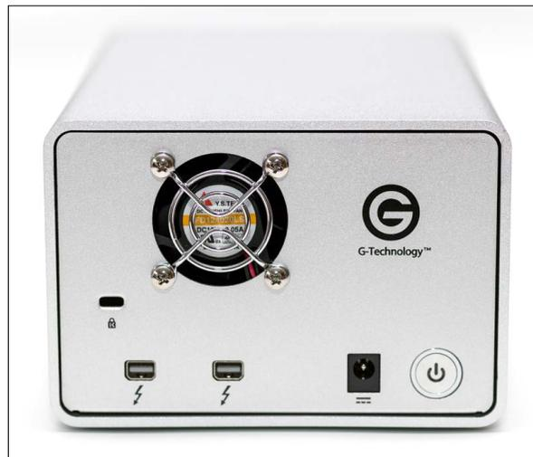
Der Lüfter springt nur bei Bedarf an. Im Test nach etwa zwei Stunden Leerlauf für ca. 5 Min. Die Geräuschentwicklung ist erträglich. Thunderbolt Daisy Chaining ist möglich.
