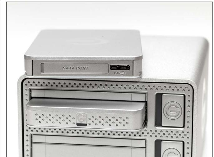
Die Verbindung im Dock erfolgt via SATA (unter der Abdeckung). Extern kann die Platte mittels USB genutzt werden.
