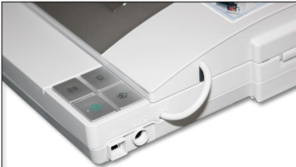
**Links:** Die Anschlüsse für das Netzteil und USB befinden sich gleich rechts neben dem Tastenfeld. Diese unorthodoxe Anordnung führt leider zu Nachteilen im Betrieb: Je nach Aufstellung des Gerätes stören entweder seitlich heraushängende Kabel, oder die Tasten befinden sich an der von Anwender abgewandten Seite des Scanners.
