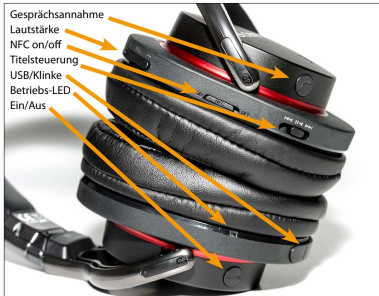
Sony sind das die meisten aktuellen Smartphones, wie das Xperia Z. Der Vorgang ist in der Tat recht simpel: Einfach an beiden Geräten NFC aktivieren, was beim MDR-1RBT über einen kleinen Schiebeschalter am rechten Hörergehäuse geschieht, dann den Kopfhörer kurz ganz nah an das Smartphone mit ebenfalls
