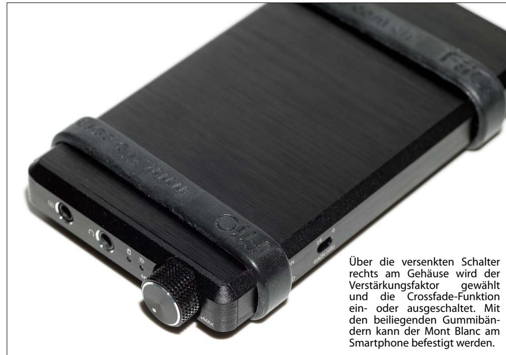
Über die versenkten Schalter rechts am Gehäuse wird der Verstärkungsfaktor gewählt und die Crossfade-Funktion ein- oder ausgeschaltet. Mit den beiliegenden Gummibändern kann der Mont Blanc am Smartphone befestigt werden.
