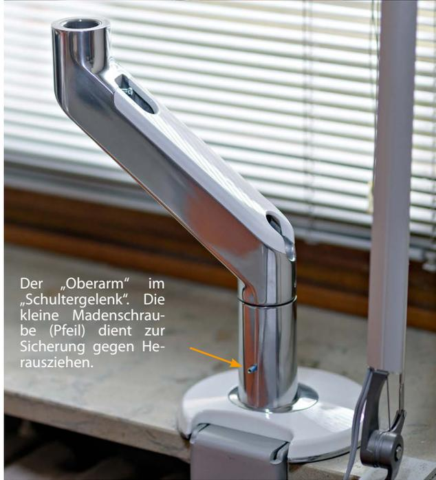
Der „Oberarm“ im „Schultergelenk“. Die kleine Madenschraube (Pfeil) dient zur Sicherung gegen Herausziehen.
