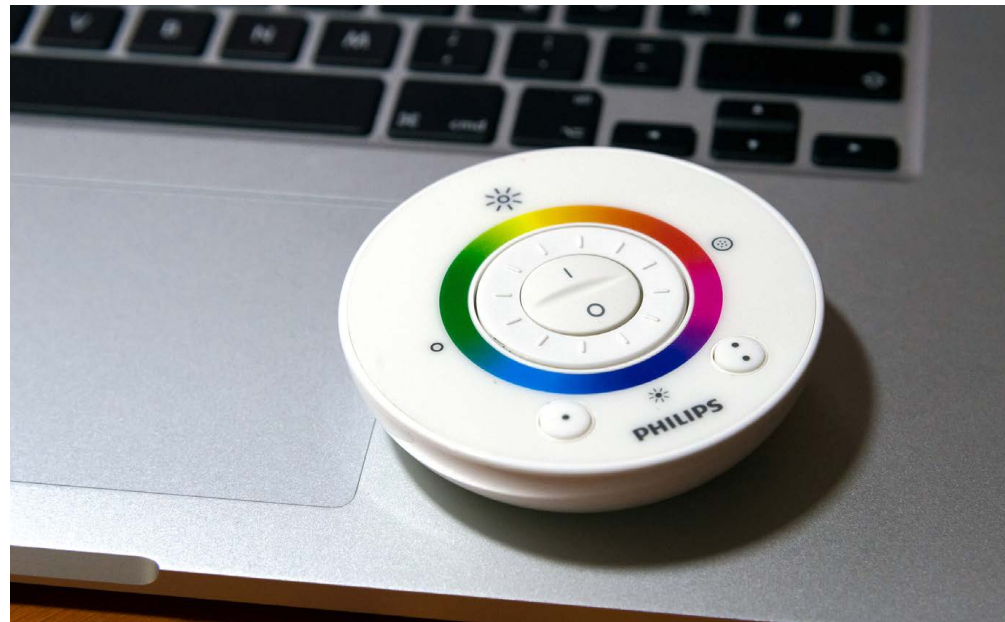
16,7 Mio. Farbstufen kann die Iris theoretisch darstellen. Die Funkfernbedienung erlaubt das „Surfen“ durch den Farbraum über das Drehrad, sowie die Variation der Farbsättigung und Helligkeit.
