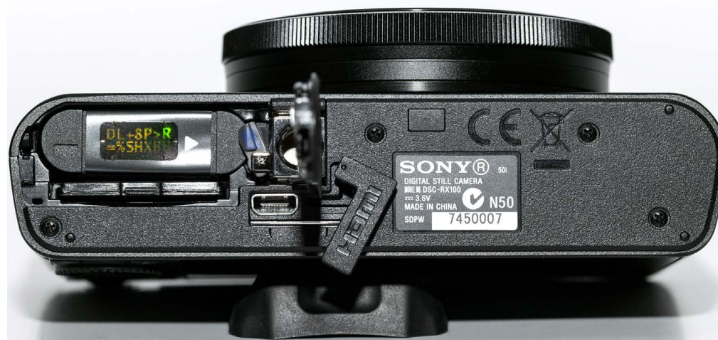
Bodenkontrolle: Leicht verdeckt hinter der geöffneten Akkufachklappe sitzt das nicht zentrierte Stativgewinde. Die SD-Karte wird im Akkufach eingesetzt. Eine weitere Klappe verbirgt den etwas ungünstig positionierten Mini HDMI-Anschluss.
