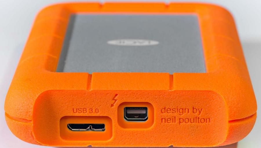
**Doppeldock:** Zum Festmachen des Schlauchbotes stehen zwei Anschlüsse parat. USB 3.0 und Thunderbolt. Die Stecker der mitgelieferten Kabel sitzen ausreichend fest in den Buchsen. Schade ist, dass kein zweiter Thunderbolt-Anschluss für „Daisy-Chaining“ vorhanden ist.
