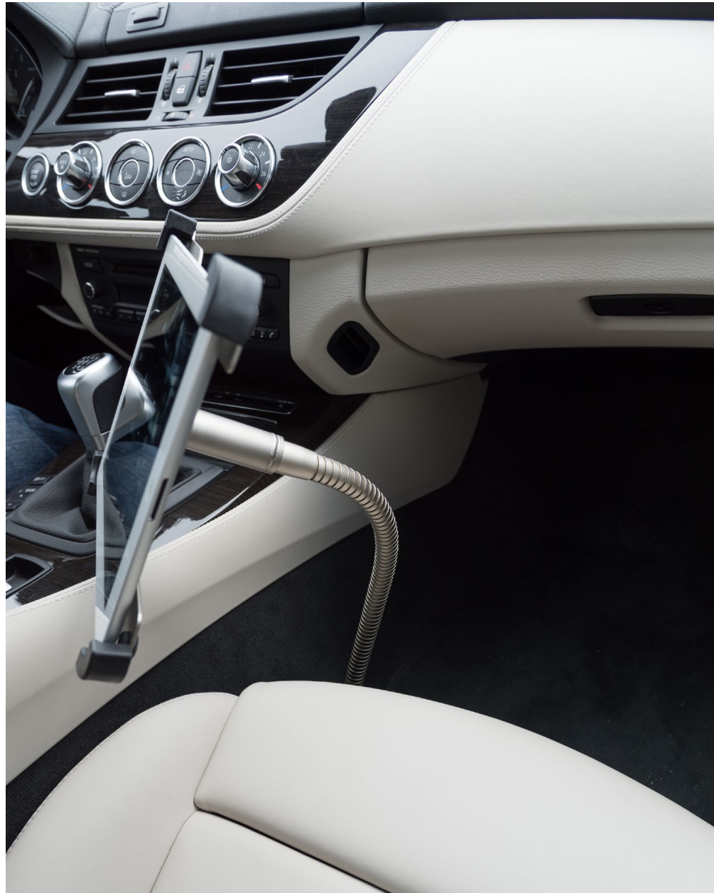
Langer Hals: Der super stabile Schwanenhals okkupiert leider den Beifahrer-Fußraum. Ist ein Passagier an Bord, kann der Halter leicht demontiert werden. Die Konstruktion ist sehr stabil, aber nicht stabil genug, um absolut schwingungsfrei zu sein. Man kann damit leben, aber es ist eine Frage des persönlichen Anspruchs.
