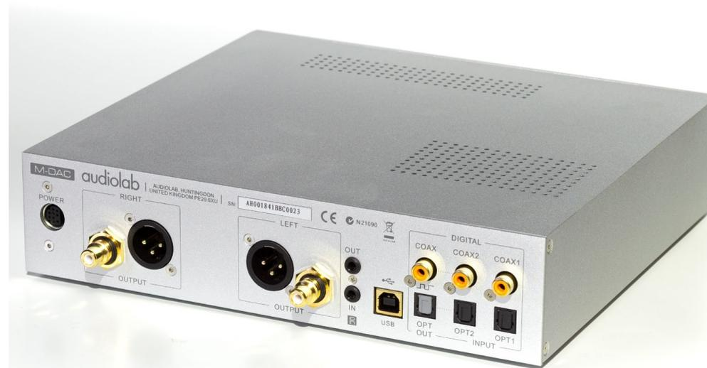
**Alles dran (fast):** Der M-DAC bietet außer analogen Eingängen praktisch alles, was man heute an Anschlussoptionen benötigt. Sogar symmetrische Analogausgänge sind vorhanden. Die kleinen Klinkenbuchsen sind Triggeranschlüsse zur Fernsteuerung kompatibler Geräte.
