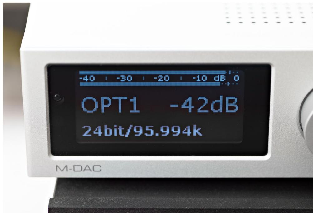
**Organisch:** Das 2,7 OLED-Display ist auch aus größerer Entfernung gut ablesbar und bietet zahlreiche Anzeigeoptionen. Die etwas ungleichmäßige Helligkeit auf dem Foto liegt an der Belichtungszeit bzw. an der Refreshrate des Displays. In Natura ist es absolut flimmerfrei und gleichmäßig hell. Aber nicht abschaltbar!
