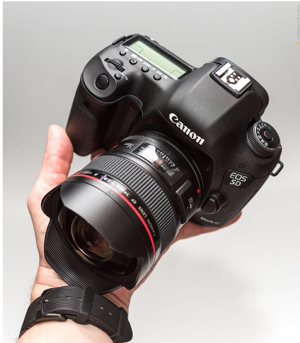
**Handliches Paket:** Natürlich zählt die 5D Mark III nicht zu den kleinsten SLRs, aber sie ist sehr handlich und wirkt in Kombination mit hochwertigen Festbrennweiten, wie hier dem 14mm f/2,8, wie aus einem Guss. Das EF 14mm 1:2,8L II USM macht an der Kamera einen ausgezeichneten Eindruck und bietet viel Fotospaß. Mit über 600g ist es aber trotz kompakter Maße ziemlich schwer.
