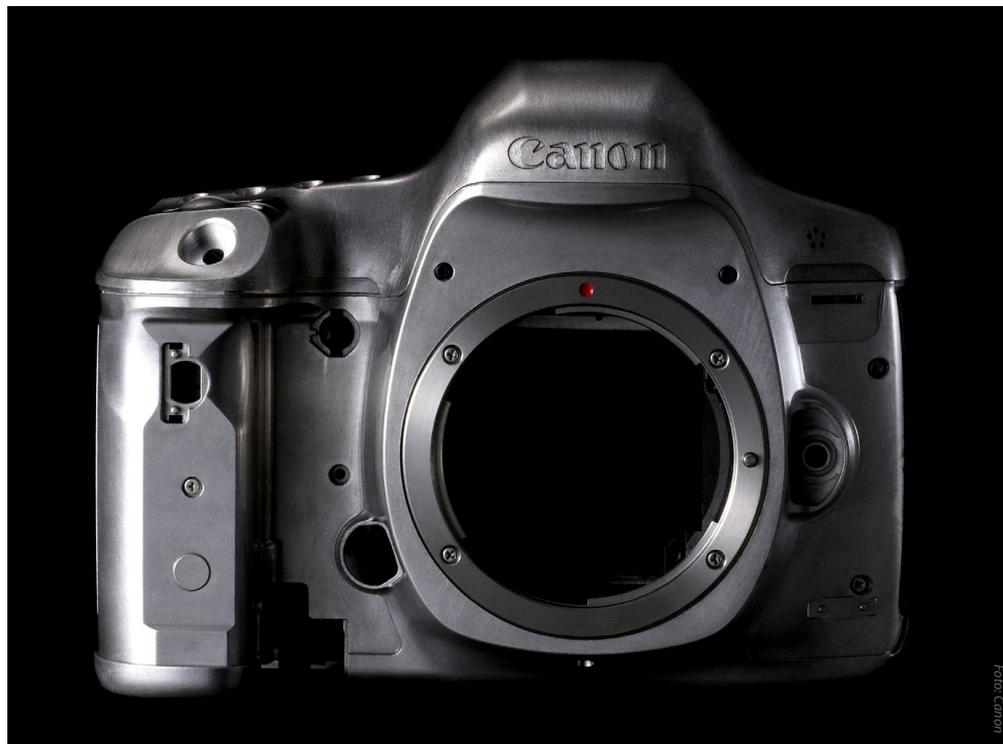
**Rock-Solid:** Das Magnesiumgehäuse der 5D III sieht nicht nur so massiv aus, wie das der Topmodelle, es fühlt sich auch so an. Die sagenumwogene EOS 3D, die nie das Licht der Welt erblickte, wird mit der 5D III weitgehend obsolet.
