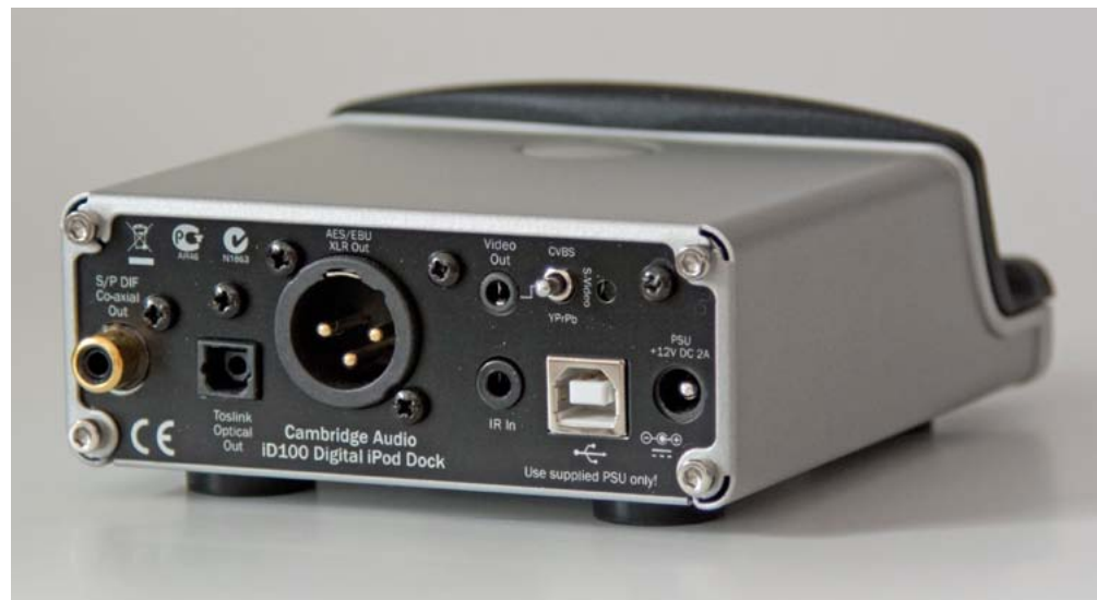
Anschlussfreudig: Für den digitalen Anschluss an externe DACs stehen Toslink, Coax Digital und AES/EBU zur Verfügung. USB dient nur zum Synchronisieren mit dem Mac oder PC.
