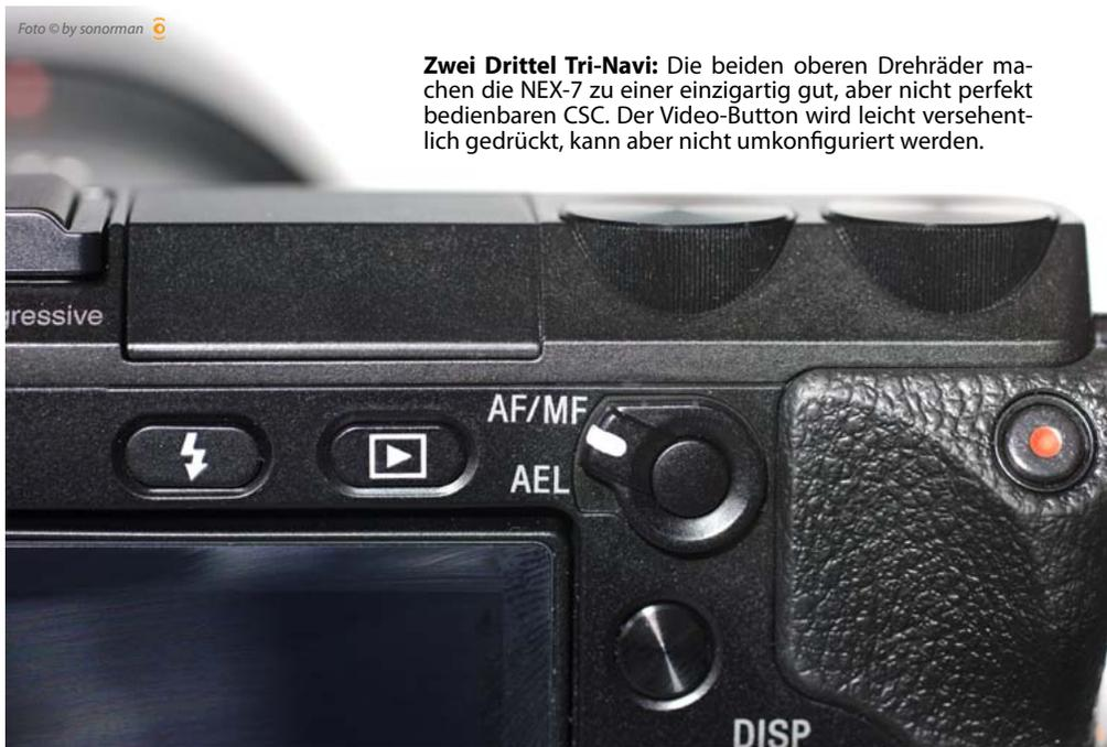
**Zwei Drittel Tri-Nav:** Die beiden oberen Drehräder machen die NEX-7 zu einer einzigartig gut, aber nicht perfekt bedienbaren CSC. Der Video-Button wird leicht versehentlich gedrückt, kann aber nicht umkonfiguriert werden.
