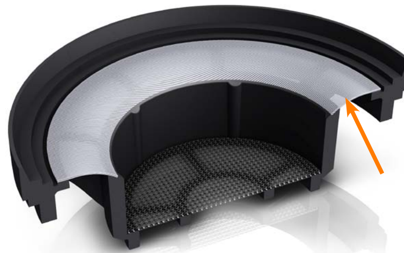
Der neu entwickelte Treiber des HD 700 setzt auf Offenheit in allen Belangen. Das luftdurchlässige Gewebe (Pfeil oben), welches die Form der Membran aufnimmt, verringert das Luftvolumen unter der Membran und sorgt so für eine noch präzisere Kontrolle der Membranbewegung und damit für weniger Verzerrungen. Ein Lochgitter (Pfeil unten) kanalisiert die Luft unterhalb des Magneten und vermindert Taumelbewegungen der Membran.
