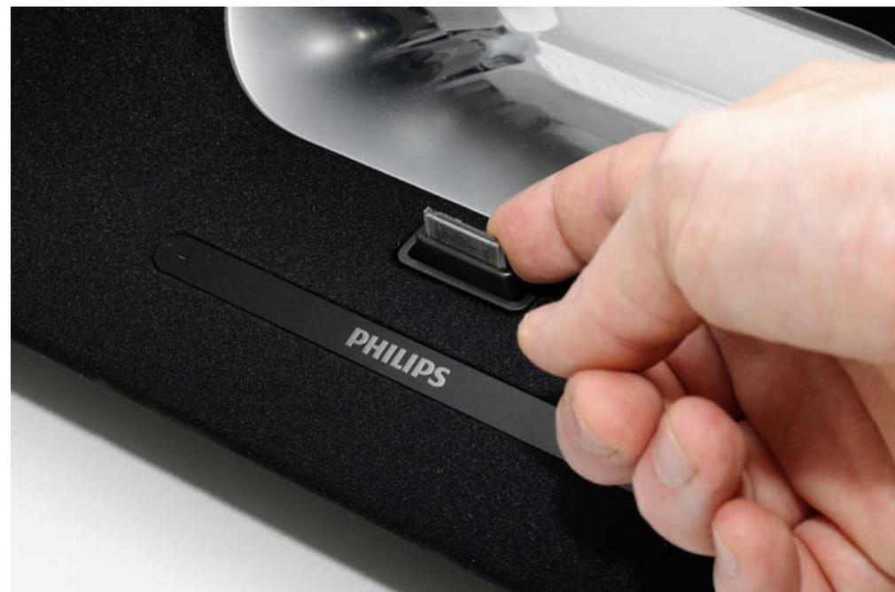
**Gelenkig:** Der Dock Connector ist federnd gelagert, so dass iDevices unterschiedlicher Dicke aufgesteckt werden können. Wegen der fehlenden, seitlichen Führung erfordert das Aufstecken vor allem des iPads etwas Übung.
