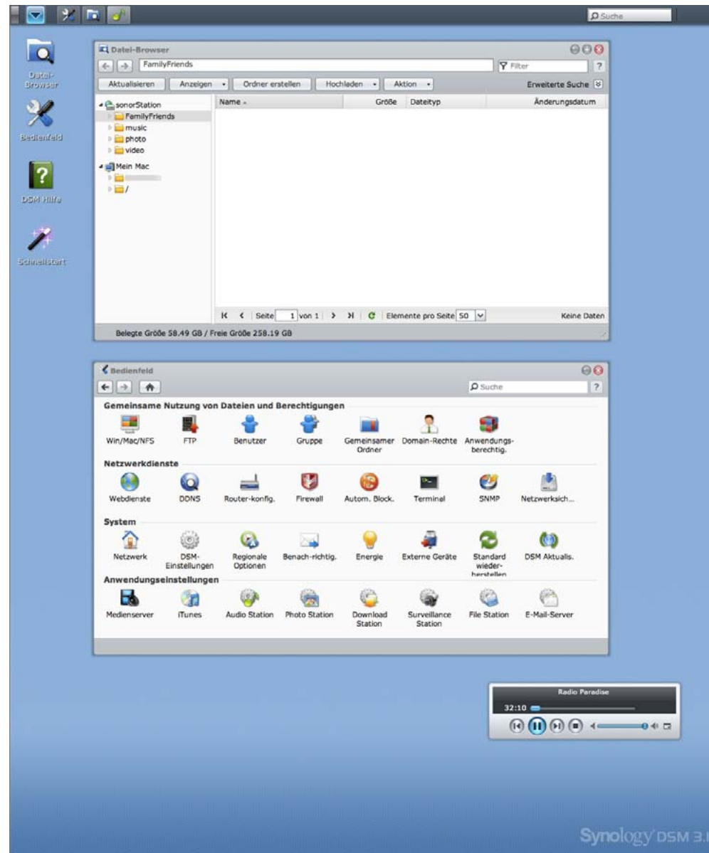
Disk Station Manager (DSM): Die Benutzeroberfläche der Synology NAS-Systemeläuft im Browser-Fenster und bietet Zugriff auf zahlreiche Applikationen und Admin-Features.
