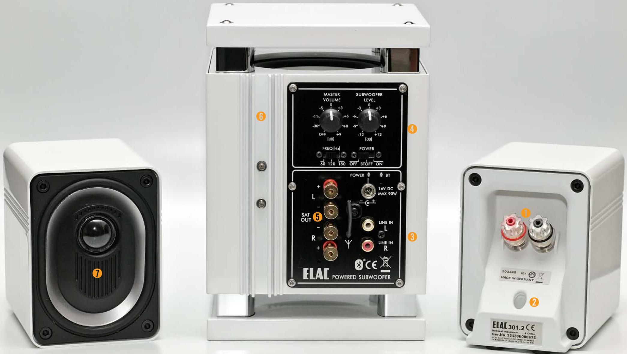
**Details:** Die kräftigen Schraubterminals eignen sich auch für Bananenstecker, wenn die Stopfen entfernt werden [1]. Das Loch [2] eignet sich entweder zur Kabelführung, oder dient zur Befestigung. Die Anschluss-Sektion an der Rückseite des Subwoofers [3]. Hier werden die Einstellungen vorgenommen [4]. Die Anschluss terminals für die Lautsprecherkabel [5]. Eine Kühlrippe [6]. Der Koaxialtreiber mit dem auf einer „Brücke“ montierten Kalottenhochtöner [7].
