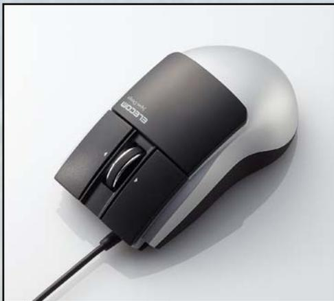
Das Kabel hat eine Länge von 1,0 Meter und wird via USB 2.0 an den Rechner angeschlossen. Die Abmessungen der Elecom Wired Laser Mouse betragen: 53,0 x 98,3 x 37,9 mm (BxTxH). Der Sensor arbeitet besonders stromsparend. Verfügbar ist die Elecom Wired Laser Mouse in schwarz oder schwarz/silber ab sofort im Fachhandel für rund 20 Euro.
