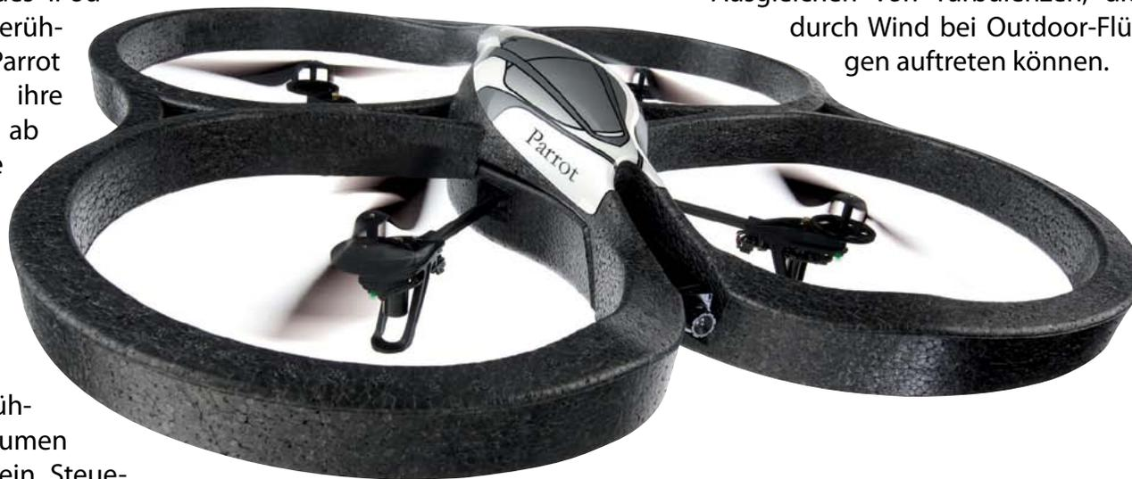
Die Parrot AR.Drone ist aus Kohlefaser und hochbelastbarem PA66-Kunststoff gefertigt. Das Herz der AR.Drone besteht aus MEMS (Micro Electro Mechanical Systems), 3-Achsen-Beschleunigungssensor, 2 Gyrometern [eine Achse & zwei Ach-
