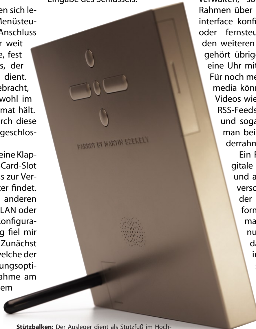
Stützbalken: Der Ausleger dient als Stützfuß im Hoch- und Querformat und ist zugleich der Netzanschluss.
