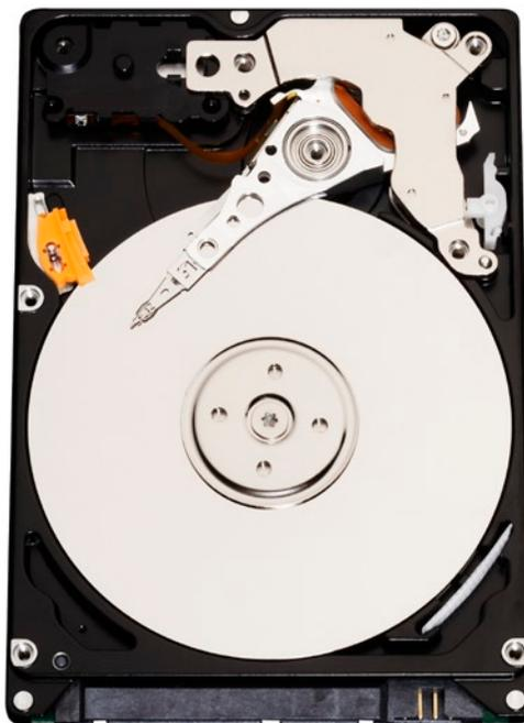
Schreib- und Lesekopf in weniger als 200 Millisekunden von der Disk, sobald die Festplatte oder das Gerät, indem sich die Festplatte befindet, hinunterfällt. Zudem bieten die neuen Produkte mit 7200 Umdrehungen pro Minute, einer SATA 3 Gb/s Schnittstelle und 16 MB Cache Leistungswerte, die mit Festplatten für Desktop-Rechner vergleichbar sind.
