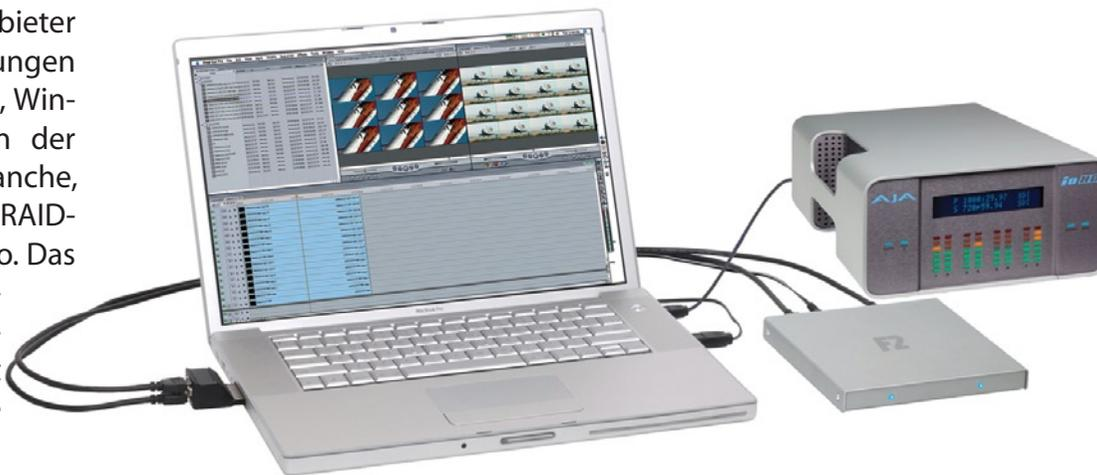
Das F2 verfügt über zwei eSATA-Anschlüsse. Als Schnittstelle an MacBook Pro und Windows-Laptops kann eine Adapterkarte wie die Sonnet Tempo SATA ExpressCard/34 dienen. Maximale Geschwindigkeit erlaubt das Fusion F2 in der RAID 0 (striped)-Konfiguration. Mit 126 MB/sec im Lese- und Schreibmodus wird nahezu die doppelte Geschwindigkeit von FireWire 800 (66 MB/sec) erreicht.
