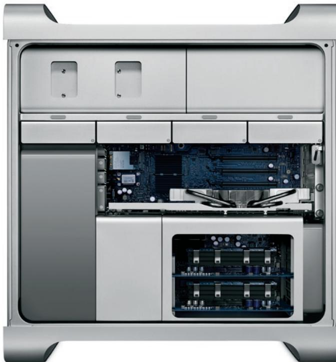
**Octopussy:** Der neue Mac Pro verfügt standardmäßig über acht Prozessorkerne dank zweier Quad-Core Intel Xeon Prozessoren.
