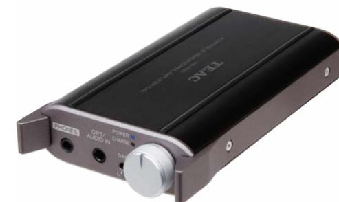
Audiosignale von einem iOS- oder Android-Gerät werden via USB digital extrahiert (16 Bit/44,1 kHz) und dann durch den integrierten Digital-Analog-Wandler des HA-P50 weiterverarbeitet. Mit minimaler Verzerrung, in reinsten Wiedergabequalität und Klangtreue – so das Versprechen. Verantwortlich hierfür ist ein BurrBrown PCM5102 Digital-Analog-Wandler, der digitale Audiosignale in einer Auflösung von bis zu 24 Bit/96
