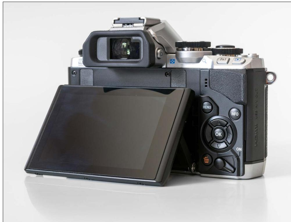
Auf dem Touch-Display markiert der Fotograf den vordersten und den hintersten Bereich im Bild, der scharf abgebildet werden soll, dann gibt man der Kamera die Anzahl der Fokusschritte vor, feuert die automati-
