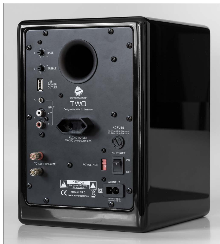
Master: Das Anschlussfeld mit dem Stromausgang für ein AirPort Express. Die USB-Buchse dient nicht für Audio. Hierüber kann beispielsweise ein iPhone-Akku geladen werden.
