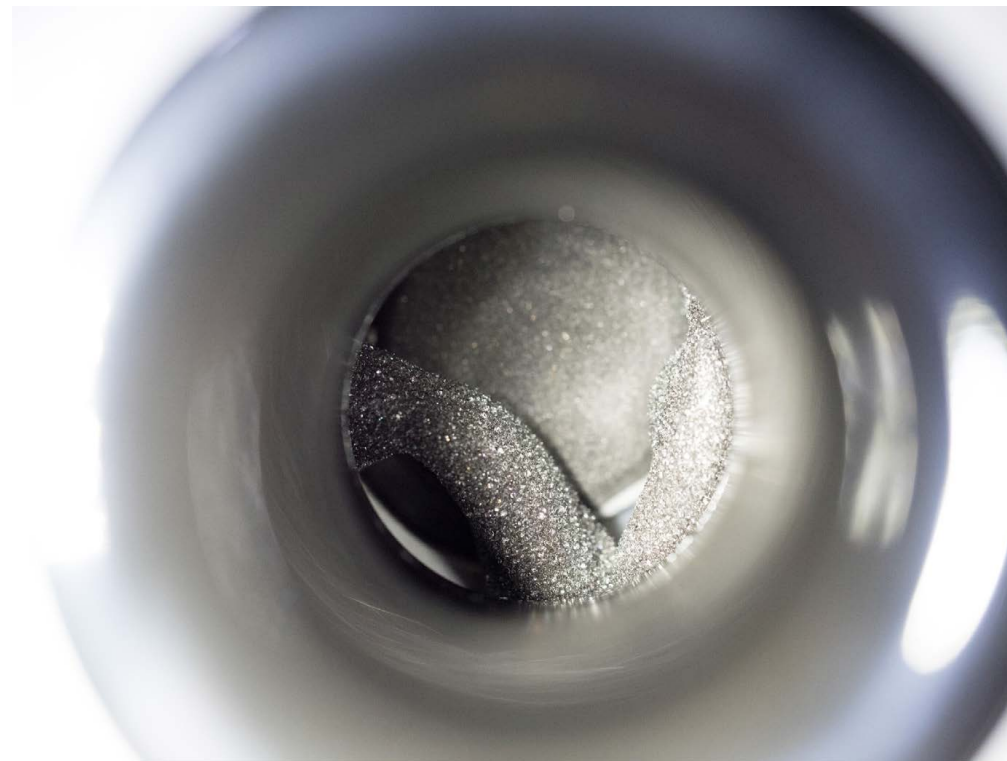
Patzer: Blick in die Bassreflexröhre. So sollte es nicht aussehen. Die mit Schaumstoff verkleideten Kabel sollten unter der Röhre verlaufen. Im Test führte dieser Montagefehler bei bestimmten Bassfrequenzen zu heftigen Resonanzen.
