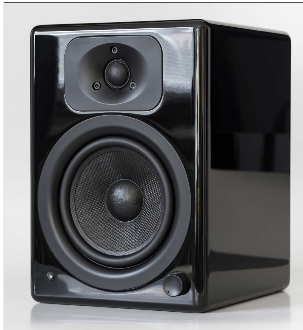
Wavemaster Two: Klassische 2-Wege Aktivkonstruktion. Unten rechts sitzt der On/Off/Lautstärkereglern, links unten die Status-LED, die im Betrieb ätzend grell blau leuchtet (rot im Standby).
