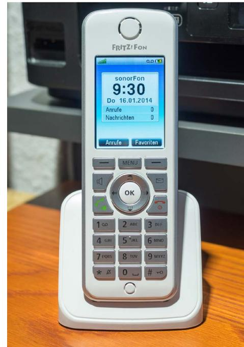
die in die Fritz!Box eingetragen werden müssten, kann ihre Telefonfunktion nur sehr eingeschränkt genutzt werden. Das DECT-Telefon muss in dem Fall mit dem TAE-Kabel an die Fritz!Box angeschlossen werden und wird quasi nur durchgeschleift. Die DECT-Anmeldung muss an der Telefon-eigenen Basisstation erfolgen, womit die Komfortmerkmale der Fritz!Box brach liegen.
