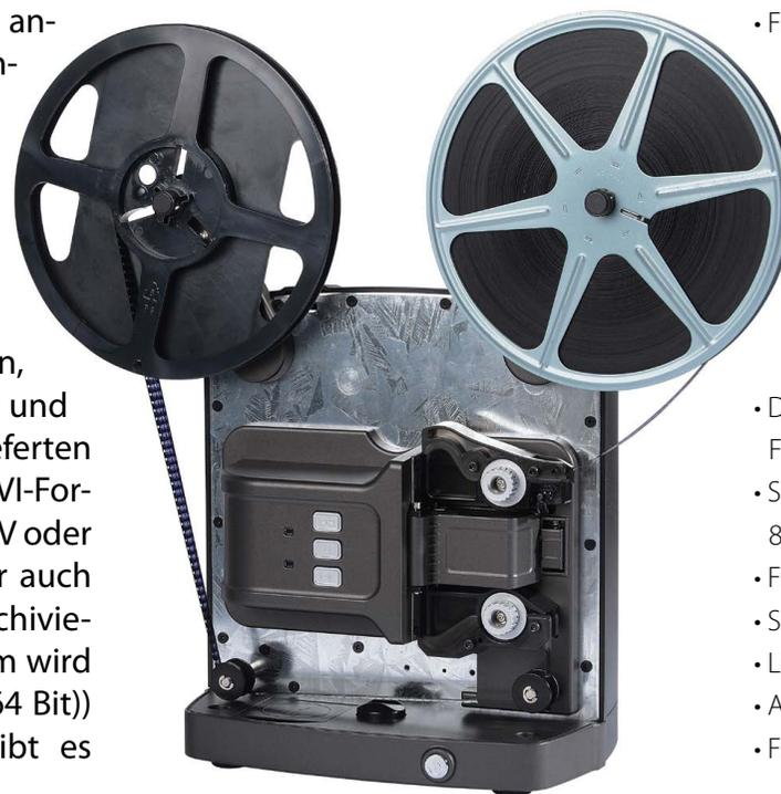
Filmrolle. Die Farbtiefe ist mit 24 Bit angegeben. Der Super 8 Scanner verfügt über einen CMOS-Sensor und eine LED-Lichtquelle. Die Auflösung beträgt entweder 1920 x 1080 (Full HD) oder 1280 x 720 (HD). Die Dateigröße für einen 15m Rollfilm in HD Qualität beträgt ca. 190 MB.
