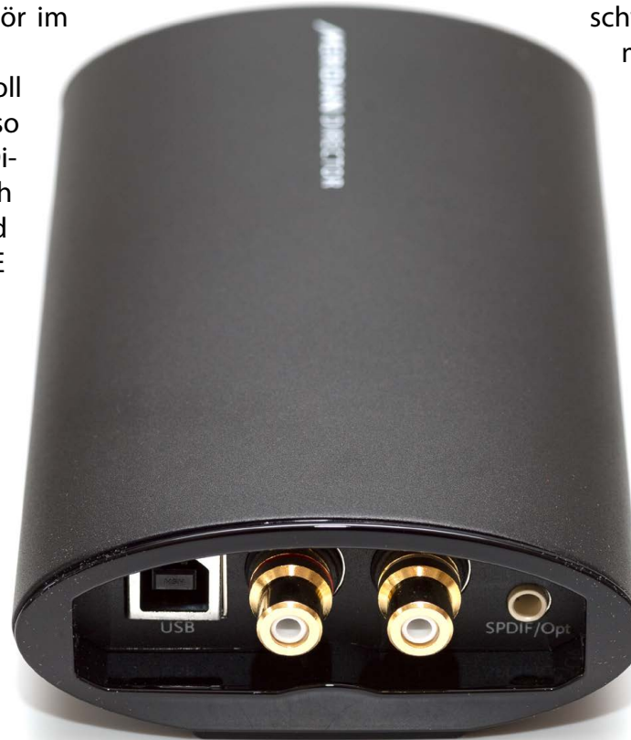
Anschlüsse: Rein geht's via asynchronem USB oder optisch/koaxial. Die analoge Ausgabe erfolgt über Stereo-Cinch.
