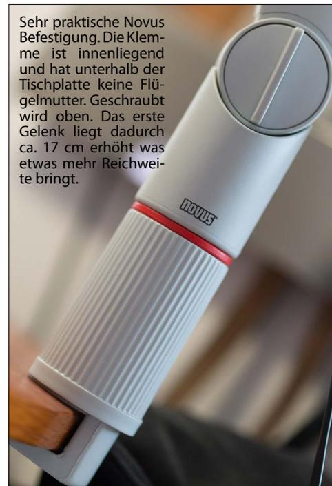
Sehr praktische Novus Befestigung. Die Klemme ist innenliegend und hat unterhalb der Tischplatte keine Flügelmutter. Geschraubt wird oben. Das erste Gelenk liegt dadurch ca. 17 cm erhöht was etwas mehr Reichweite bringt.
