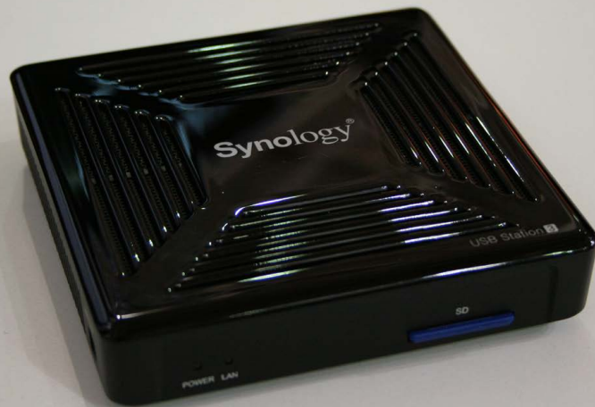
Synology USB Station 3: Eine Art Mini-NAS für USB-Festplatten. Die dritte Version kommt mit zwei USB 3.0 Anschlüssen und SD-Kartenslot (4 GB vorinstalliert). Preis: vermutlich knapp unter 100 Euro.
