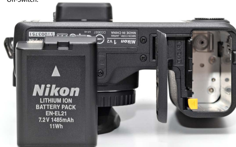
Unterseite: Zentriertes Stativgewinde (verdeckt). Der Akku ist etwas schwächer als der in der V1, bietet aber dennoch vergleichsweise viel Saft. Keine Gehäuseversiegelungen.
