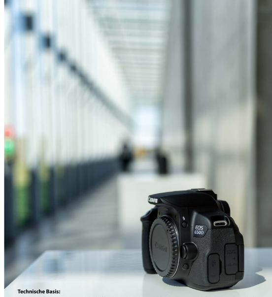
Canons Aufsteiger-SLR EOS 650D liefert die technische Basis der EOS M. Sowohl der Sensor, als auch die Elektronik sind in weiten Teilen identisch, wie auch die Bedienung per Touch-Display.
