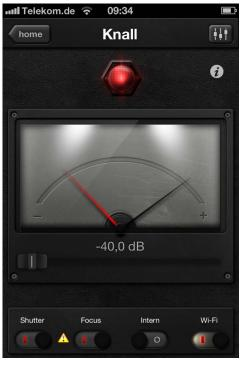
Smartphones oder Tablets mit installierter Triggertrap-App dienen und die Kameras der angeschlossenen Geräte kabellos ansteuern. Alternativ zu einem vorhandenen WiFi Netzwerk kann der "Persönlicher Hotspot" in den Einstellungen des Master-Geräts verwendet werden.
