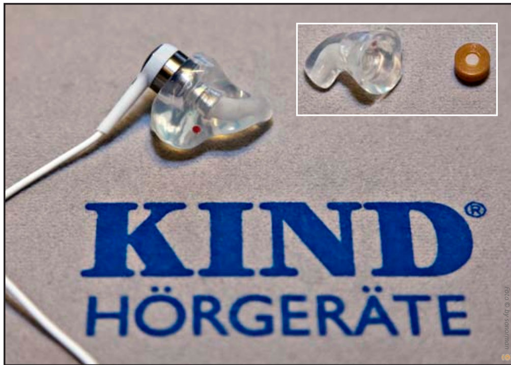
Tontunnel: Anhand der transparenten Version einer Otoplastik kann man sehr schön die Schallführung erkennen. Oben klein eingerahmt: der Akustik-Filter, den man bei Bedarf in die Öffnung für den Ohrhörer einsetzen kann.
